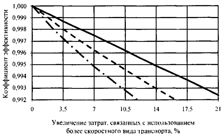
Рис. 5.5. Зависимость коэффициента эффективности функционирования ГПОТ от использования более скоростного вида транспорта: — тариф 5 руб.; — — — — тариф 7 руб.; — · — · — тариф 10 руб.
