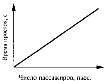
Рис. 2.9. Изменение времени простоев на промежуточных остановках в зависимости от числа входящих и выходящих пассажиров.
